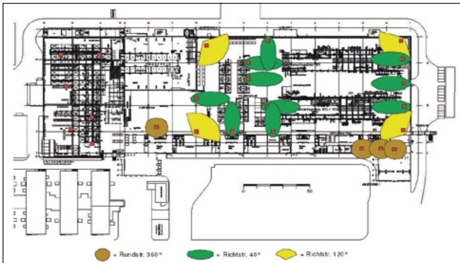
Bild 3. Die Funkübertragung für das fahrerlose Transportsystem: Das WLAN ist in dezidierte Access Domains (separate SSIDs für FTS-WLAN und ein weiteres WLAN-Netz) aufgeteilt.
